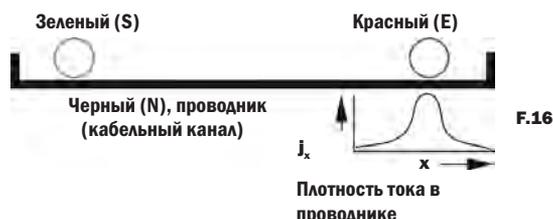
Расстояние между красным и зеленым кабелем должно быть в 5-10 раз больше диаметра большего кабеля.
