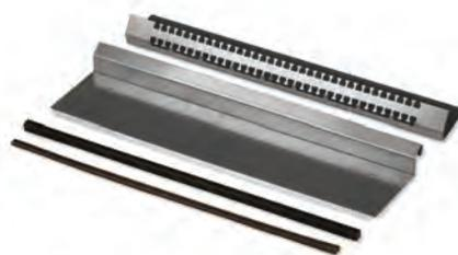
**Описание:** Заменяет две части стандартной панели основания. Благодаря молоточковидной гребенке, ЭМС кабели могут быть непосредственно заземлены на панель основаниям, полностью сохраняя электростатический экран.
