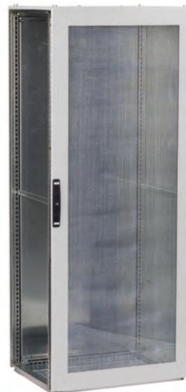
**Описание:** Стандартная дверь с прозрачным безопасным стеклом для обзора установленного оборудования. Укомплектована замком с двойной бородкой 3 мм. Позволяет устанавливать все замки из программы. Герметизация достигается при помощи проводящего полиуретанового ЭМС уплотнителя. Для снижения электромагнитного влияния за стеклом установлена проволочная сетка (61%). Используйте комплект петель DMK если ранее не была установлена другая дверь.
