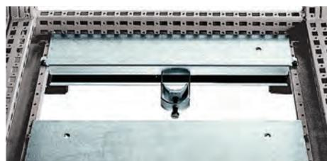
**Описание:** Устанавливается над панелями основания для оптимизации внутреннего пространства шкафа. Служит для крепления зажимов САС, позволяющих фиксировать входящий кабель. Полностью регулируемая глубина установки. При подключении кабелей заземления с ЭМС-экранированием к рейке для фиксации кабелей сохраняется эффект Фарадея, обеспечивающий оптимальное экранирование от ЭМИ.
