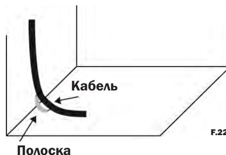
Практически такое же негативное воздействие, как при вводе нефильрованного кабеля сквозь ЭМС-экран, влечет за собой ввод кабеля через щель в стенке корпуса. Если это все же необходимо, рекомендуется соединить обе стороны щели при помощи короткой многожильной перемычки.
