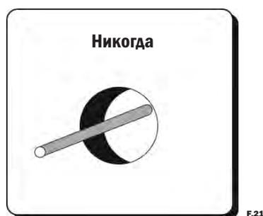
Необходимо обеспечить прямое электрическое соединение со стенкой корпуса. При вводе кабеля нужно использовать ЭМС-сальник (см. Рис. 12).
