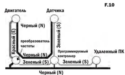
В нашей конкретной ситуации черный проводник расположен между мотором и датчиком в конструкции машины. Неудобно изгибать его вдоль кабелей, чтобы получить более пригодное решение, когда кабели проходят вдоль конструкции. Но до тех пор, пока корпус с частотным преобразователем, подключенный к ЛЭП, не встроен в конструкцию системы, это останется сложной задачей. Нам придется искать альтернативные решения.
